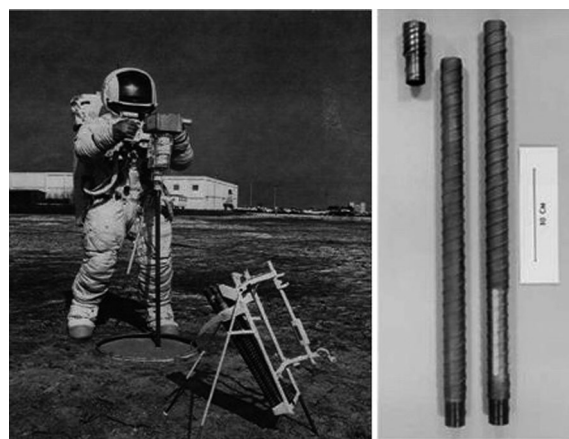
(b) ALSD 回转冲击钻机及其取心钻具
